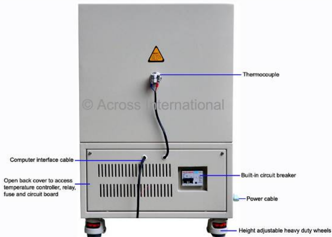
Figura 21: Fornaci da 1200°C, vista anteriore e posteriore; queste fornaci sono equipaggiate con elementi resistivi in Kanthal, refrattari in allumina sinterizzata e sistemi di controllo termico a più rampe. Spesso dotate anche di uscita seriale per l'interfacciamento al PC
