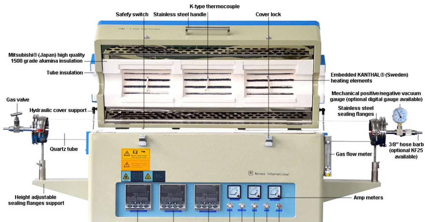
Figura 27: Forno tubolare a tre zone: 1400°C, 1600°C, 1400°C con atmosfera controllata, adatto ai trattamenti di semiconduttori
