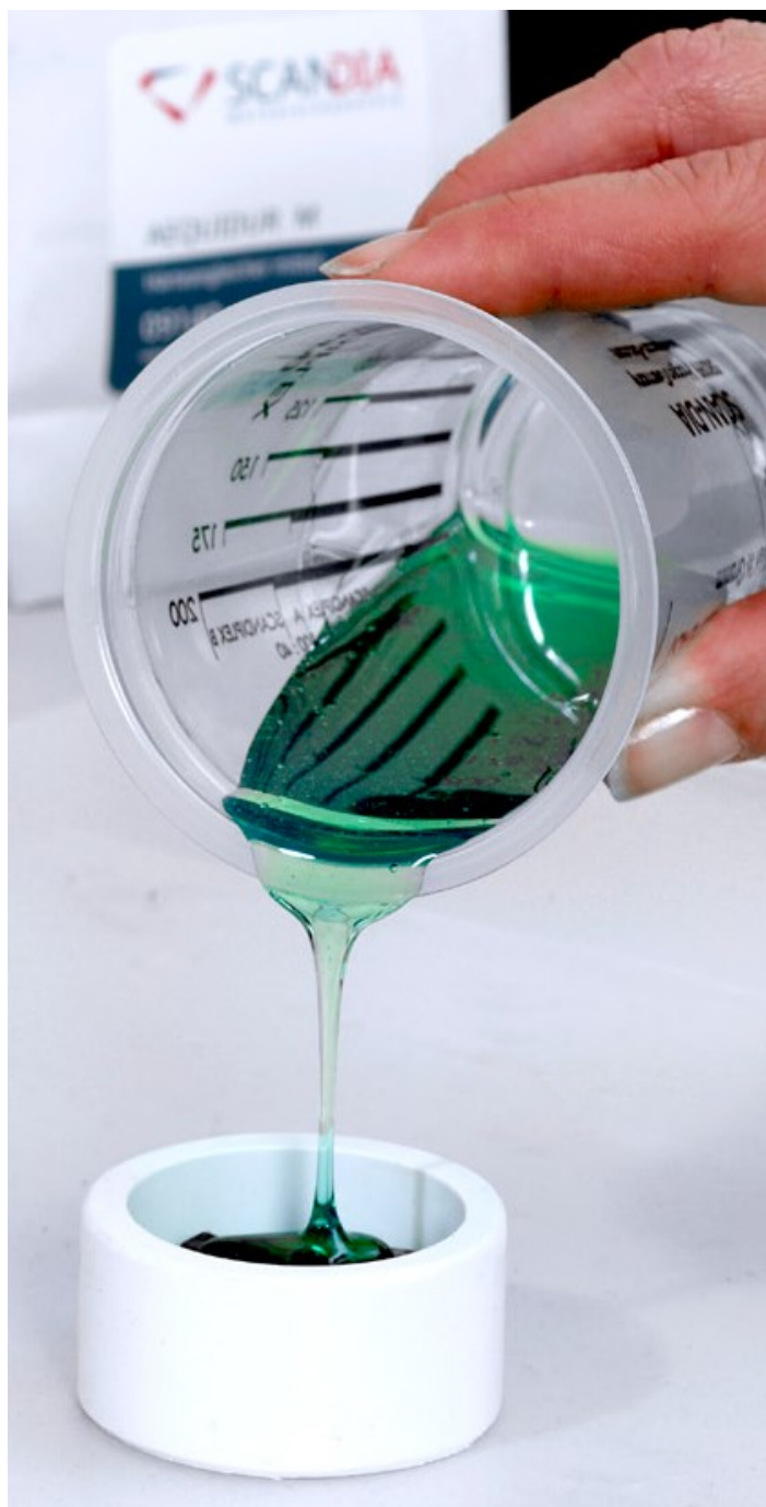
Figura 31:ampioni inglobati in resina poliestere
